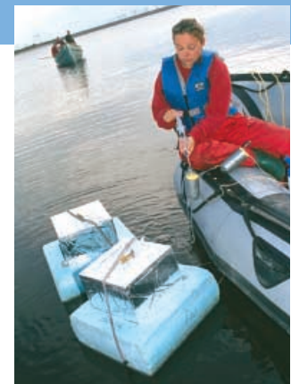
Chambres flottantes pour mesurer les GES
